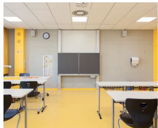
Die Sichtbetonwände mit ihrer originären Ausdruckskraft geben der Raumatmosphäre prägenden Charakter.
